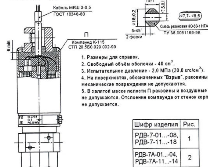
Рисунок А.3 – Чертеж средств взрывозащиты распределителя
